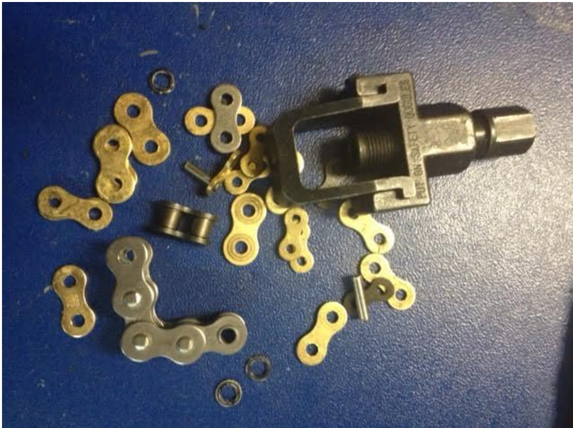
Рисунок 1. Звенья цепей и резьбовой прессик для разборки
